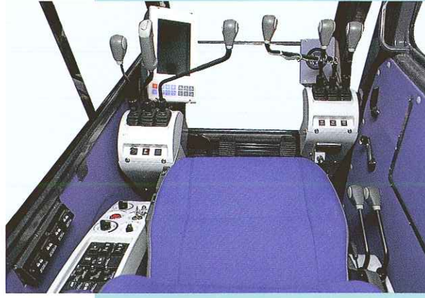
人間工学的に配慮された運転装置 グラフィックディスプレイの モーメントリミッタと 作業のしやすい操作レバー群
