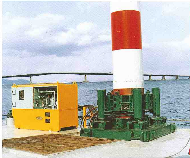
HC200TWS-813型 作業船スパット昇降装置
